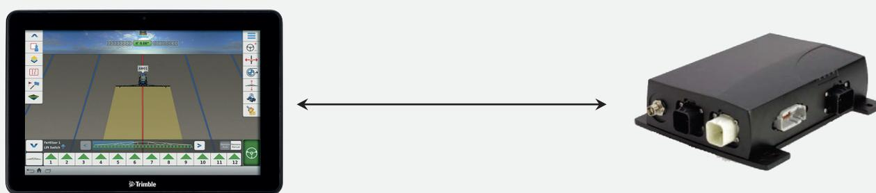
2. Connectez le câble adaptateur TRIMB au port du terminal
