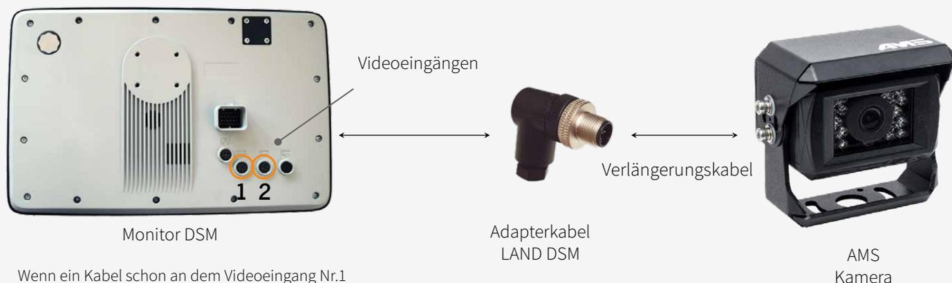
Wenn ein Kabel schon an dem Videoeingang Nr.1 angeschlossen ist, ziehen Sie bitte es aus und schließen Sie unser Kabel an.
