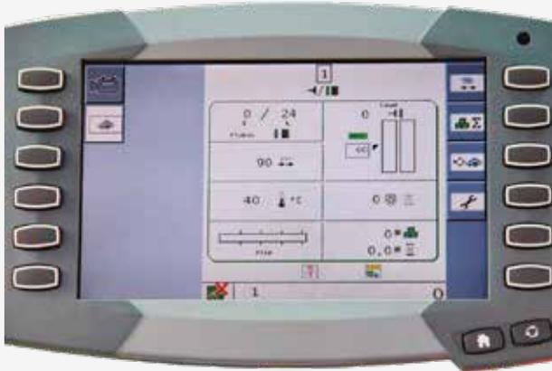
Ihren Originalen Monitor DATATRONIC 4 detektiert automatisch den Anschluss einer Kamera.
