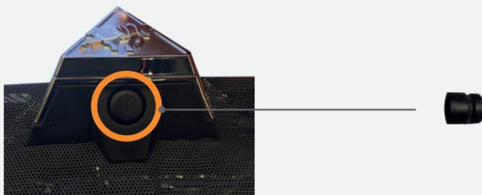
2. Installieren Sie die Kamera von vorne an der Kameraeinbaustelle. Der weiße Punkt zeigt die Richtung der Bildanzeige an.
