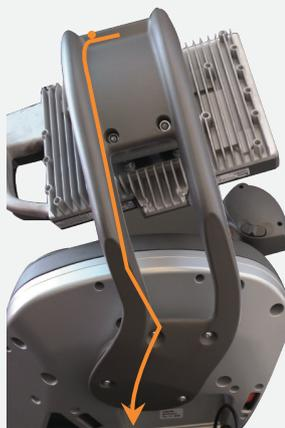
Far passare il cavo nel braccio di mantenimento del monitor verso il braccio
