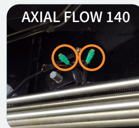
Sous l'aile gauche (près du boîtier H-Bridge 2) : 2 entrées vidéos
